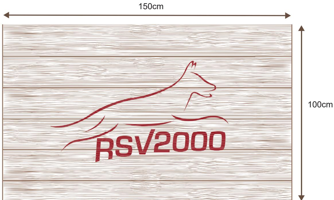
Die Schrägwand hat eine Höhe von 180cm und eine Breite von 150cm. Der Abstand der Schrägwände am Boden beträgt 130cm. Die ganze Fläche der Schrägwand muss mit einem rutschfesten Belag belegt sein. An den Wänden sind in der oberen Hälfte je 3 Steigleisten 24/48mm angebracht.
